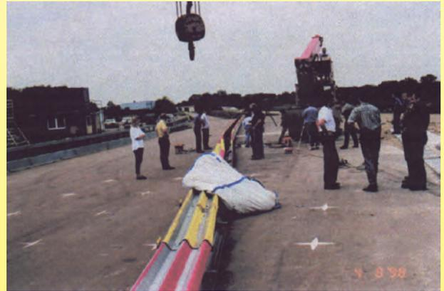
Aufgrund der Ergebnisse mit verschiedenen Aufprallversuchen in der B.A.S. erfolgte eine Umkonstruktion, so dass die Wand nach dem Umfallen bereits nach 25 Metern wieder senkrecht stand. Alle auf dem Markt befindlichen Produkte mussten anschließend mit zusätzlichen Drehelementen ausgerüstet werden.
