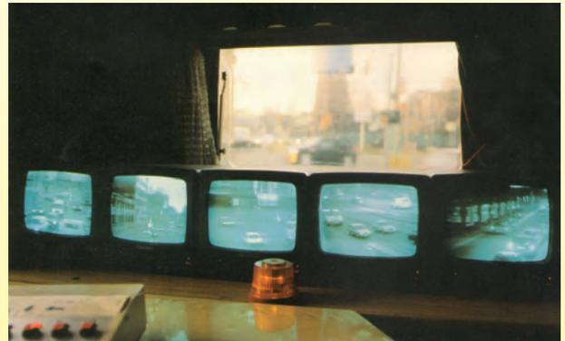
Durch Einsatz von Videokameras lassen sich unübersichtliche Verkehrsknoten mit mobilen Signalanlagen individuell steuern.
