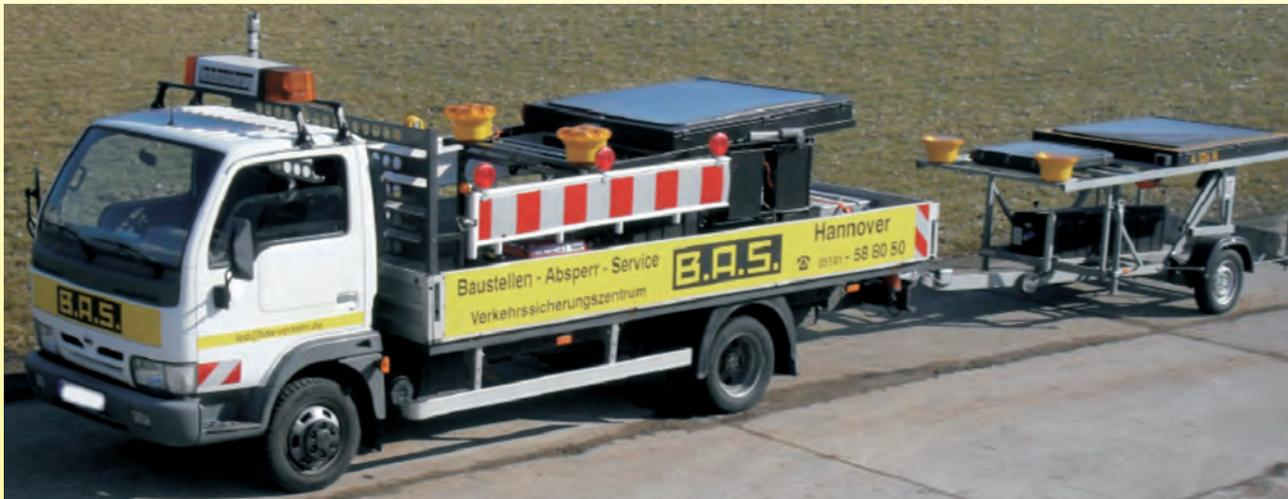
Bei einer Vollsperrung zeigt der abgestellte Anhänger an der Zufahrt zur BAB die Sperrung. Nach der Abkuppelung fährt das Sicherungsfahrzeug auf die Autobahn, setzt zurück, klappt die mit dem Sperrvermerk versehene LED-Tafel auf und sperrt mit den ausgeklappten, innenbeleuchteten Flügeln die gesamte Fahrbahn. Die Polizei kann wieder abrücken.
