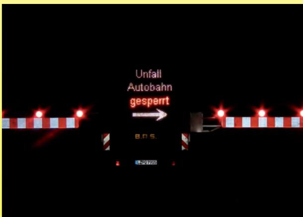
Ist durch einen Unfall nur ein Teil der Fahrbahn beeinträchtigt, zeigt in entsprechender Entfernung zur Unfallstelle der auf dem Seitenstreifen abgestellte LED-Anhänger die zu erwartenden Fahrverhältnisse. Die SES sichert dann die Unfallstelle. Bei Dunkelheit wird mit dem blendfreien Leuchtbalken der Unfallbereich ausgeleuchtet, so dass eine schnellere Räumung erfolgen kann.
