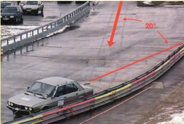
Um Frontalzusammenstöße im Baustellenbereich zu vermeiden, erfolgte die Entwicklung transportabler Stahlschutzwände. Die BAST erteilte der zur Prüfung eingereichten B.A.S.-Stahlschutzwand ein sehr gutes Prüfzeugnis. Beim ersten Einsatz gab es jedoch eine Überraschung. Durch einem PKW-Unfall rollten sich die Stahlschutzwände im Dominoeffekt über 5 km Länge auf die Seite.
