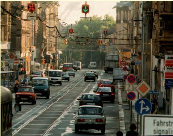
Kraftfahrzeuge sollten die Straßenbahn als ÖPNV nicht behindern. Durch oberhalb des Gleisbereiches angebrachte Signalgeber mit gelben, rechtsweisenden Blinkpfeilen und anschließendem roten Kreuz räumten in Leipzig Kraftfahrer den Gleisbereich vor der Straßenbahn. Nach der Durchfahrt erfolgte unverzüglich wieder eine Freigabe für den Kraftfahrer.
