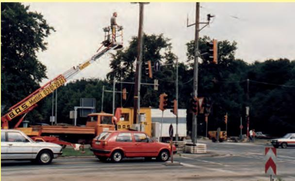
Das Postenhäuschen stand links neben wartenden LKWs. Die austretenden Abgase ergaben Probleme für den Signalposten. Der Einsatz einer B.A.S.-Hubarbeitsbühne löste dieses Problem. Gleichzeitig erhielt man einen besseren Überblick, so dass eine sehr gute Verkehrssteuerung möglich war.
