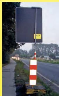
Leitbaken sind nur für den Kraftverkehr. 2010 erfolgte von der B.A.S. die Einführung von Schutzbaken für Geh- und Radwege.
