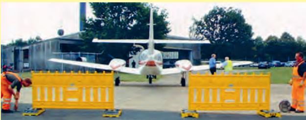
Mit einem Flugzeug wurden unterschiedliche Windstärken erzeugt und die Standfestigkeit des Arbeitsstellenzaunes geprüft.
