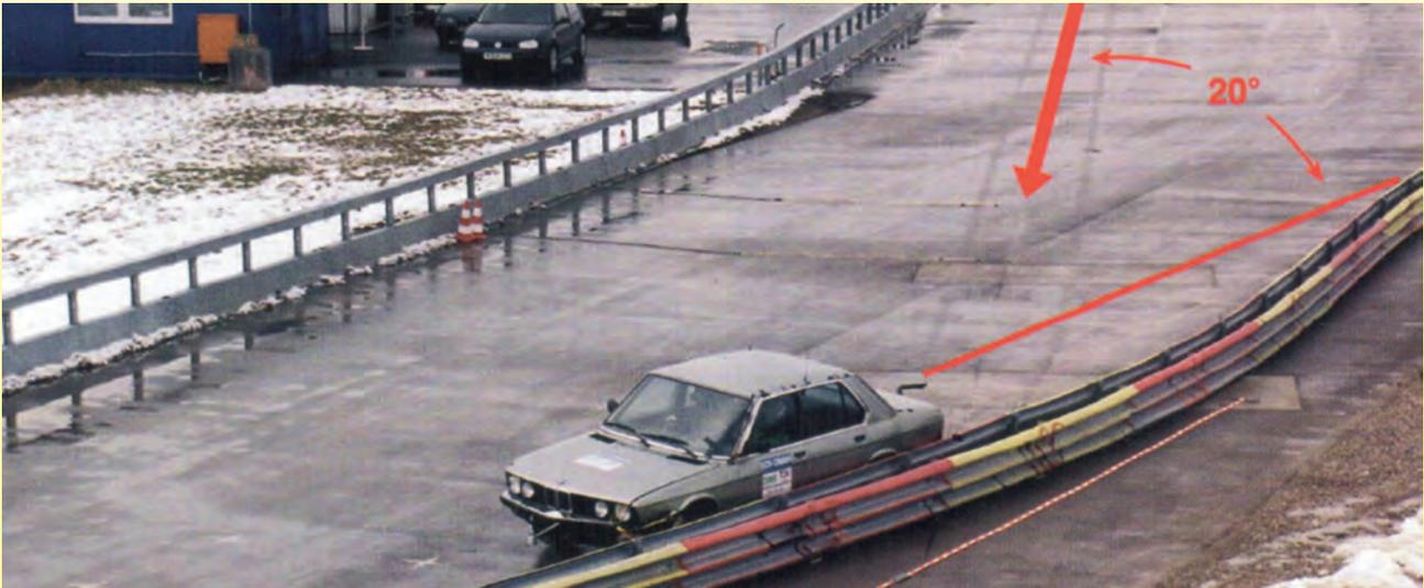
Nach verschiedenen Aufprallversuchen in der B.A.S. erfolgte eine Umkonstruktion, so dass die Wand nach dem Umfallen bereits nach 25 Metern wieder senkrecht
