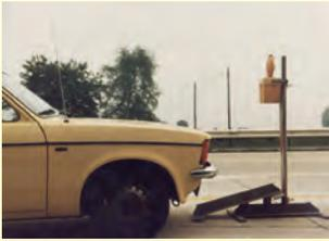
Absperrungen sind „Hindernisse“ und somit Gefahrenstellen für Verkehrsteilnehmer. Damals dafür eingesetzte Stahlfußplatten beschädigten bei einem Unfall die Ölwannen der Kraftfahrzeuge. Angebaute Warnleuchten flogen zum Teil wie Geschosse in die Höhe oder in die Windschutzscheiben.
