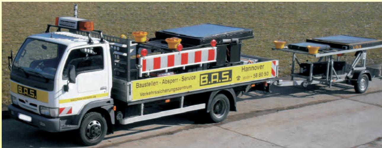
Bei Vollsperrung einer Zufahrt zur BAB zeigt der abgestellte Anhänger die Sperrung an. Nach der Abkuppelung fährt das Sicherungsfahrzeug auf die Autobahn, setzt zurück, klappt die mit dem Sperrvermerk versehene LED-Tafel und Richtungspfeil auf und sperrt mit den ausgeklappten, innenbeleuchteten Flügeln die gesamte Fahrbahn. Die Polizei kann wieder abrücken.
