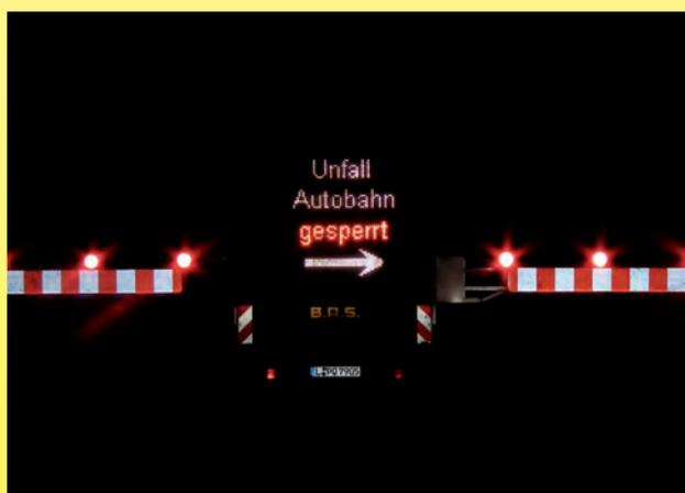
Das am LED-Anhänger und an der SES befestigte Doppler-Radargerät erfasst den vorbeifließenden Verkehr, damit die Verkehrslenkungszentrale einschließlich gezeigtem Signalbild und Standort über das Geschehen vor Ort informiert wird. Über 90 verschiedene Symbole oder Texte sind bereits fest einprogrammiert
