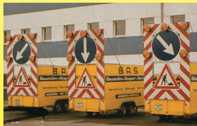
Die ersten Sicherungsfahrzeuge für Mitarbeiter an Straßenbaustellen, die durch den erhöhten Aufbau auch über vorausfahrende PKW sichtbar waren.
